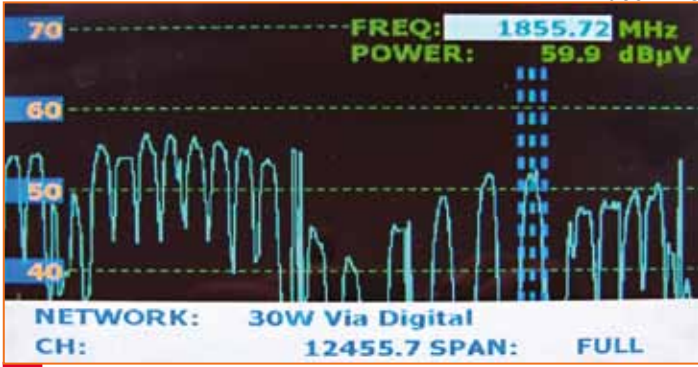
ספקטרום אותות נקלטים מהלוויין Hispasat 30° מערב, בעזרת כבל קואקסיאלי
