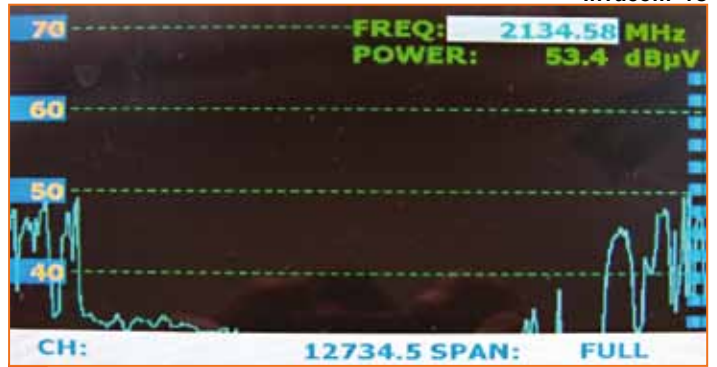
ספקטרום אותות נקלטים מהלוויין NSS7 22° מערב, בעזרת כבל קואקסיאלי
