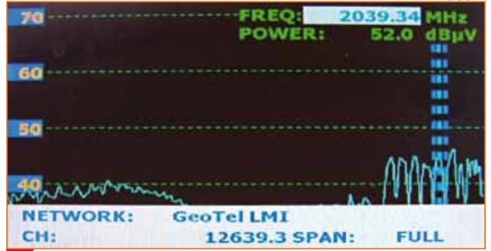
ספקטרום אותות נקלטים מהלוויין ABS1 75° מזרח, בעזרת כבל קואקסיאלי
