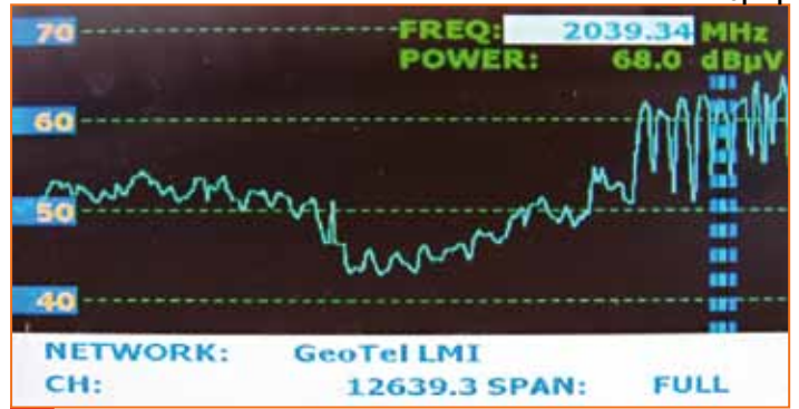
ספקטרום אותות נקלטים מהלוויין ABS1 75° מזרח, בעזרת רכיב LNB של Invacom
